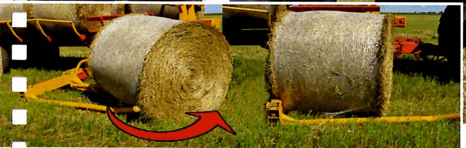
La zampa idraulica universale in movimento apre il rotolo e lo carica sulla piattaforma
