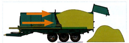
La metà del fondo si muove con la parete anteriore
