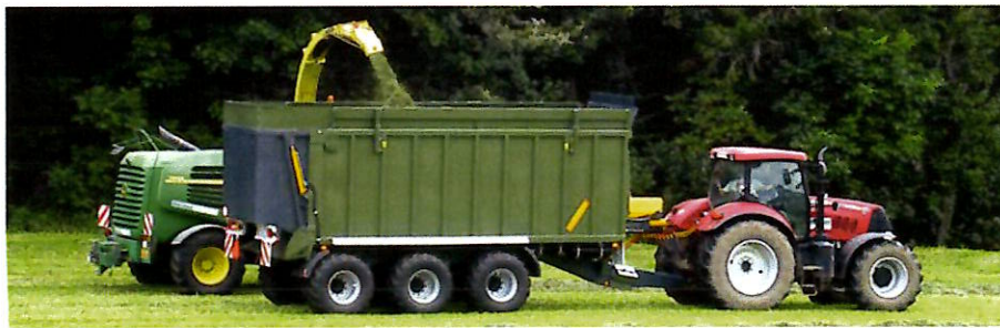
La metà del fondo si muove con la parete anteriore
