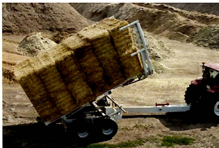
Lo scarico del semirimorchio per balle su una superficie piana e solida richiede 30-40 secondi
